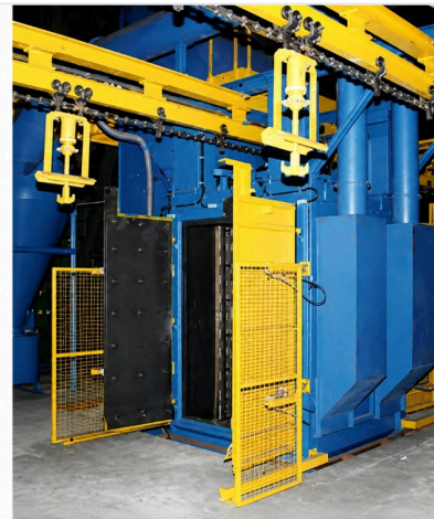
Granalladora de cabina
