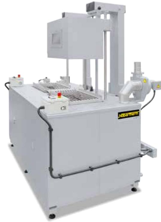
Baño de enfriamiento combinado de aceite y de limpieza, con mesas sumergibles, cubierta de protección, separador de aceite y aspiración
