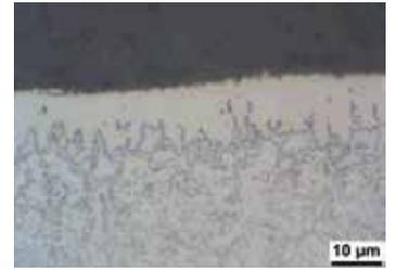
Imagen detallada de la metalografía de un acero resistente al calor, borurado en polvo
