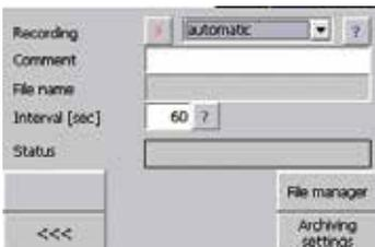
Los datos guardados en el dispositivo de memoria USB (hasta 80.000 registros de datos, formato CSV) se pueden evaluar, a continuación, en el PC, o por medio de NTGraph, o bien por un programa de hoja de cálculo (p.ej. MS-Excel) del cliente.
