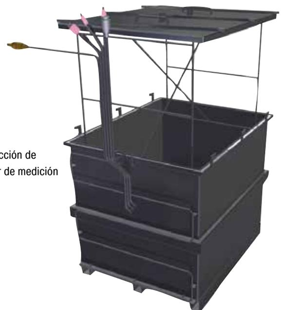
Para la realización de la medición de la homogeneidad de la temperatura (TUS) en la caja de protección de gas, dicha caja se dota de una segunda tapa. En esta segunda tapa se encuentra fijado el bastidor de medición que presenta una boquilla de paso para los termopares para realizar el TUS.
