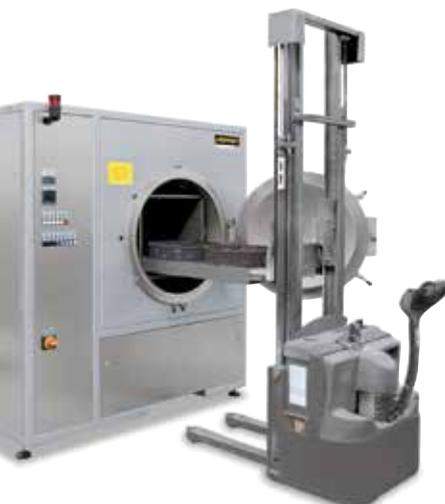
Carga del horno de retorta NRA 300/06 mediante una carretilla elevadora
