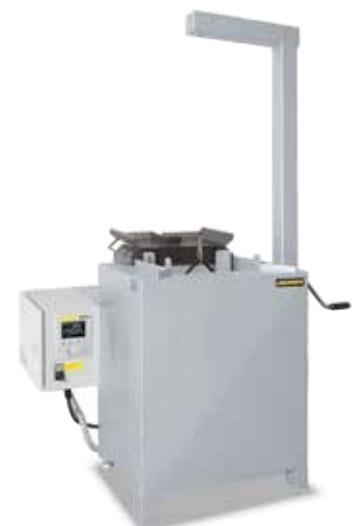
Horno isotérmico QS 30 con medio auxiliar de carga
