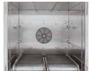
Transportador de rodillos en el horno de cámara con circulación de aire N 250/85HA
