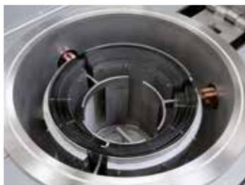
Retorta cilíndrica con calefacción de wolframio
