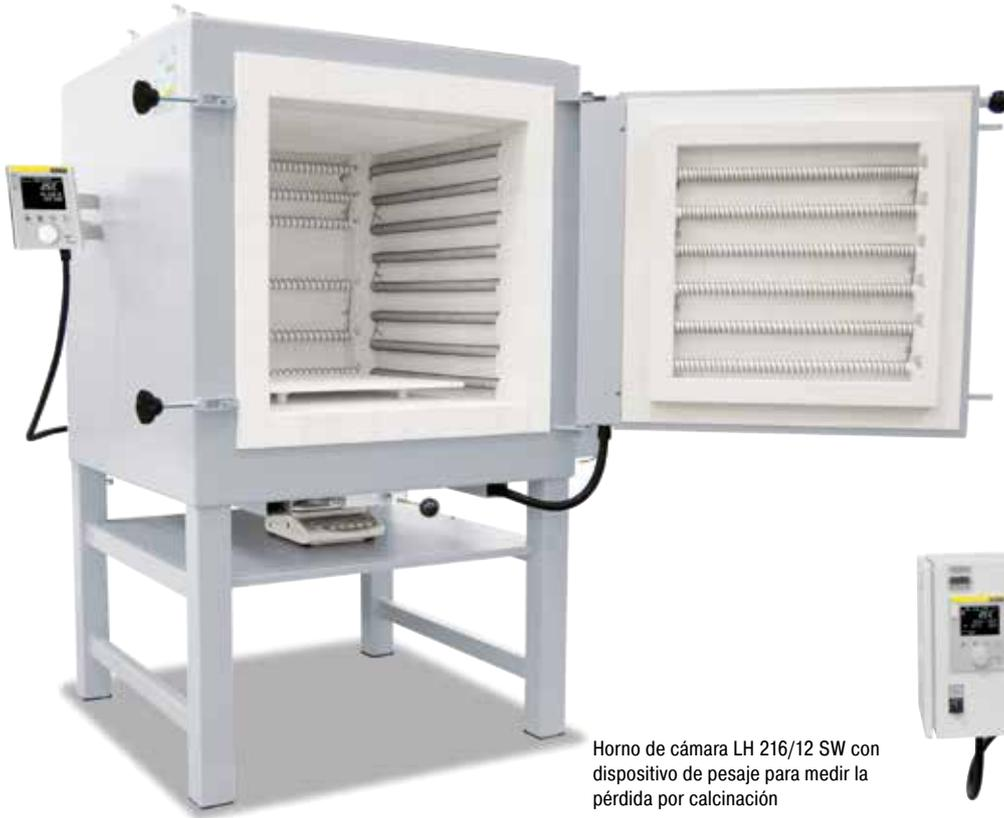
Horno de cámara LH 216/12 SW con dispositivo de pesaje para medir la pérdida por calcinación
