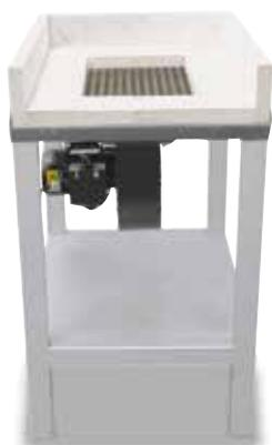
Las mesas de enfriamiento sirven para el enfriamiento forzado de componentes y cajas de recocido fuera del horno. Además, la mesa puede usarse para cargar la caja antes de introducirla en el horno.
