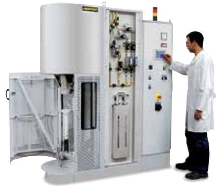
Horno tubular RHTV 120/480/16 LBS con tubo de trabajo cerrado por un lado, opción de gas inerte y vacío, así como plataforma elevadora con accionamiento de husillo eléctrico
