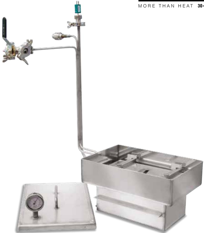
Modelo como el de las cajas descritas anteriormente, pero con tapa de vacío adicional y la correspondiente conexión. Antes de introducir la caja en el horno, se van creando en estado frío sucesivamente un vacío y una atmósfera de gas protectora para expulsar el oxígeno y conseguir una atmósfera pura.
