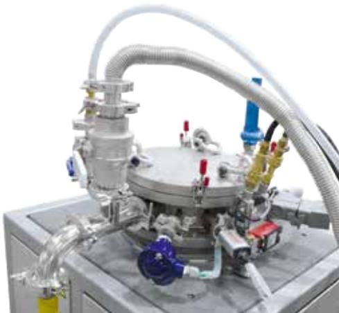
Retorta con conductos de vacío y de gas protector, conexiones de agua de refrigeración así como termopares y sensores de presión
