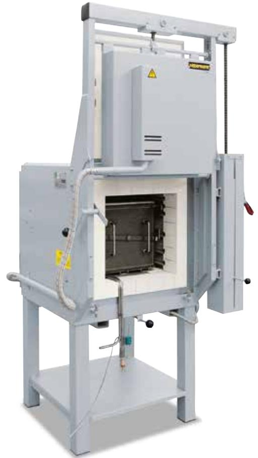
LH 60/12 con puerta guillotina manual y caja de gasificación para gases protectores o reactivos no inflamables
