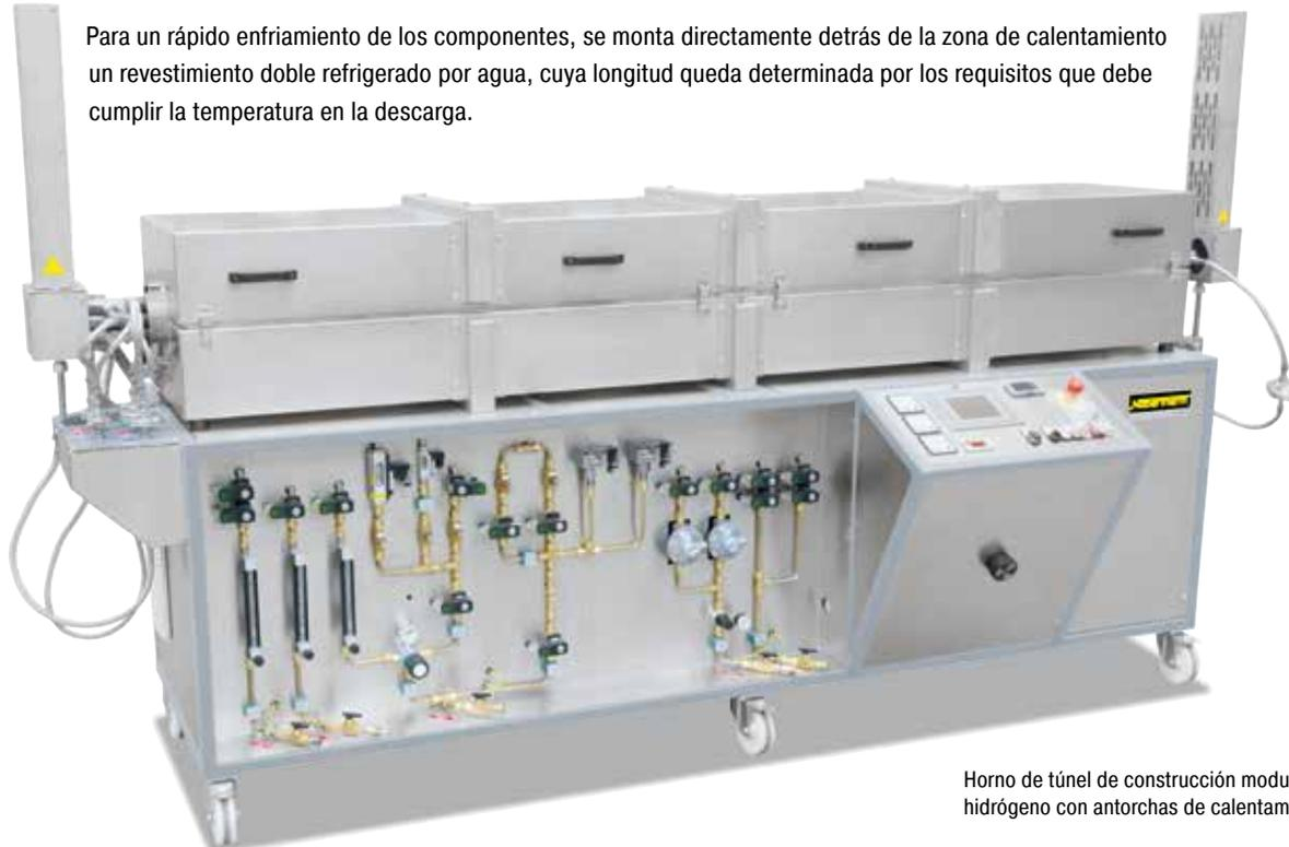
Horno de túnel de construcción modular para el funcionamiento en atmósfera de hidrógeno con antorchas de calentamiento eléctrico en los extremos
