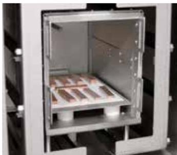
Tratamiento térmico de varillas de cobre bajo hidrógeno en horno de retorta VHT 8/16-MO
