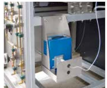
Bomba de ácido para ácido nítrico
