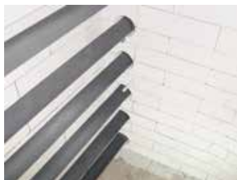
Calentamiento por ambos lados por barras de SiC de alto rendimiento
