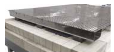
Soporte para la carga fabricado con chapa perforada
