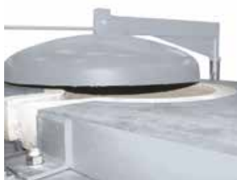
Tapa girable con buen cierre hermético sobre el cuello voladizo contra la pérdida de calor sobre la abertura del crisol
