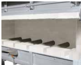
Calentamiento por gas indirecto con tubos de radiación
