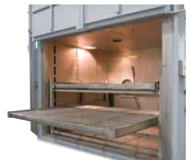
Bandeja extraíble para cargas pesadas para acoger grandes cargas
