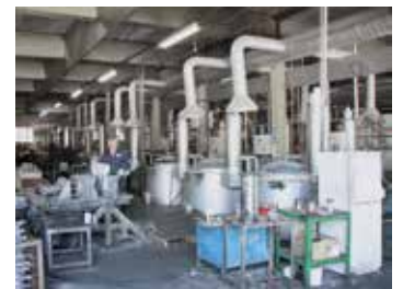
Quemador recuperador en un horno de fundición de aluminio 16 x TBR 110/12 y 2 x TBR 180/12
