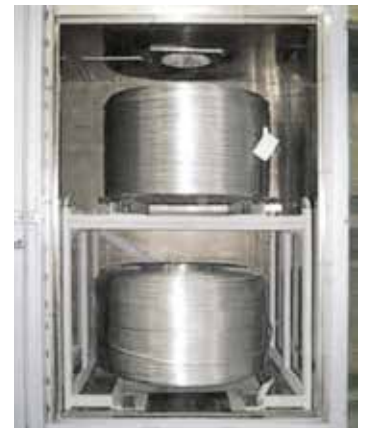
Transferencia térmica entre un lote frío y uno caliente
