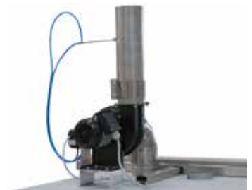
Apertura de aire entrante y ventilación potente para la salida de aire, montado encima del horno
