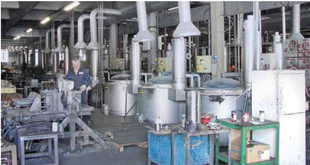
Producción con 16 hornos de crisol TBR 100/11 y 2 hornos de crisol TBR 180/11
