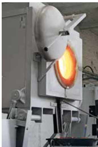
Horno de crisol basculante K 40/13 con caño extendido (Fundición de esculturas Knaak)
