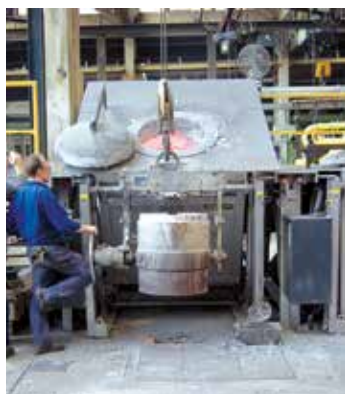
Carga del cazo de transporte con un horno de crisol basculante K 360/12
