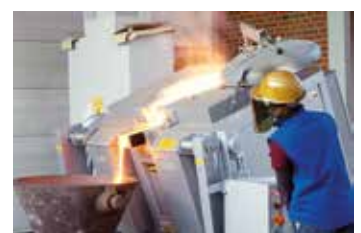
Horno de crisol basculante KC 80/14 durante la fundición
