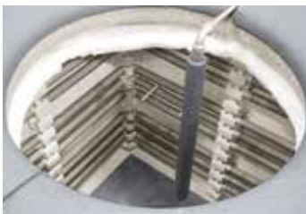
Estructura de un horno de mantenimiento de calor con regulación del baño de masa fundida con elementos térmicos para masa fundida, cámara del horno y limitador de la selección de temperatura
