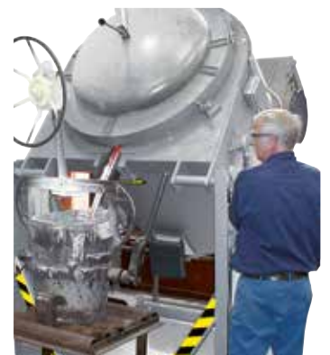
Horno de crisol basculante KB 240/12 para la fundición fusión de aleaciones de aluminio
