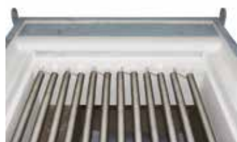
Calentamiento desde la tapa, fácil recambio de los elementos calefactores
