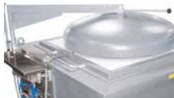
Regulación del baño de fusión con termopar en la masa fundida
