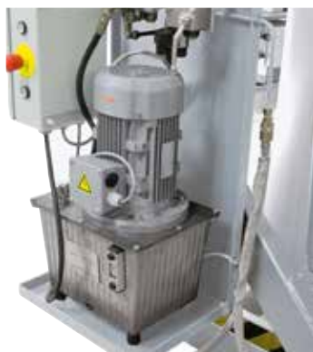
Grupo hidráulico con líquido hidráulico difícilmente inflamable
