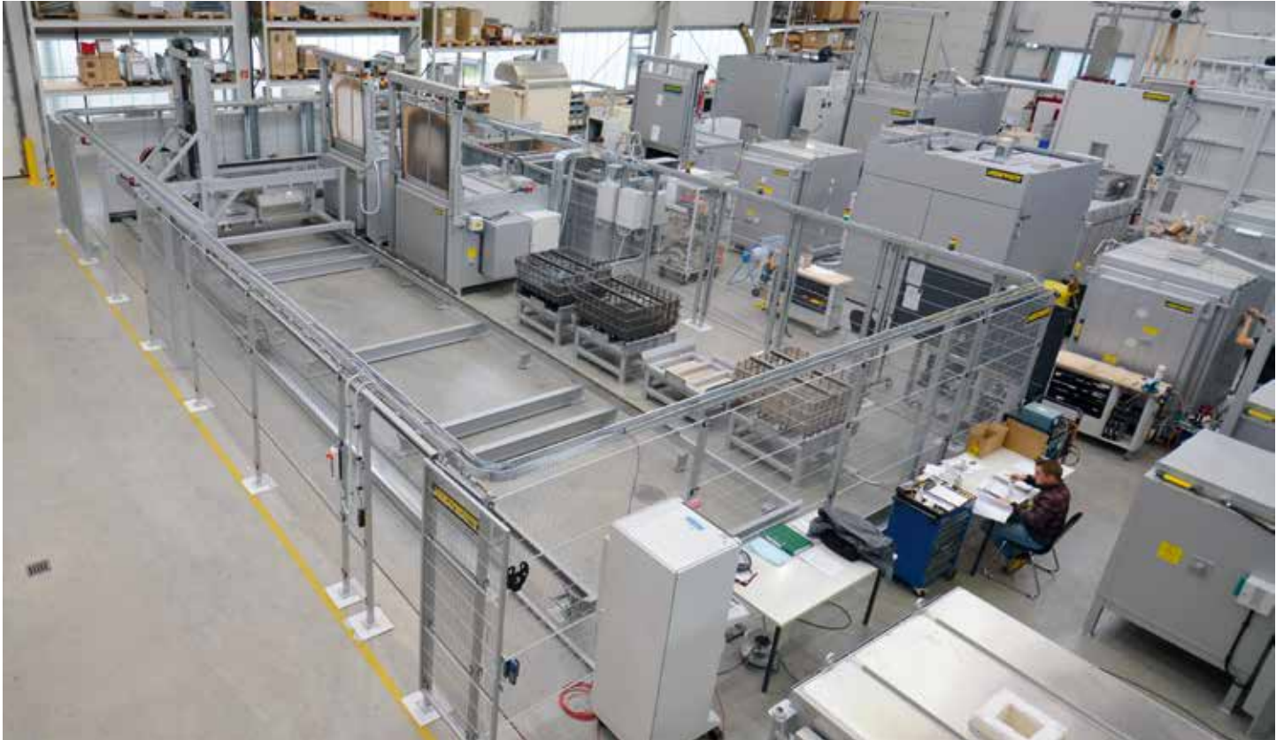
Equipo de revenido totalmente automatizado con dos hornos de cámara, baño de enfriamiento, tecnología de transporte y puesto de estacionamiento para cuatro cestas de carga
