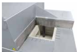
Termopar para baño de masa fundida en la cubeta de la abertura de extracción
