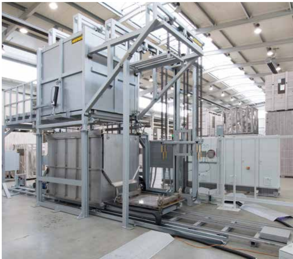
Horno de apertura inferior totalmente automático con baño de agua móvil incl. puesto de estacionamiento para cargar y grúa de descarga
