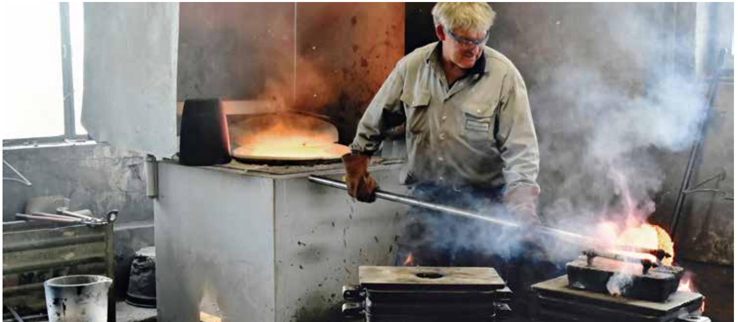
Horno de cazo T80/13 en una fundición de bronce a la arena
