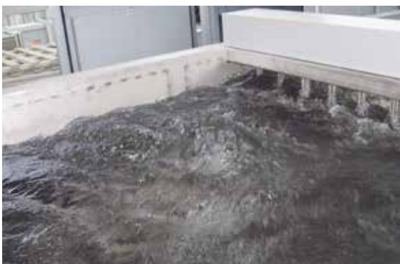
Potente circulación del medio de enfriamiento
