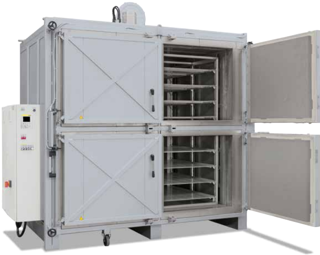
Horno de cámara con circulación de aire N 6600/60HAS con cuatro puertas independientes y rack de carga extraíble
