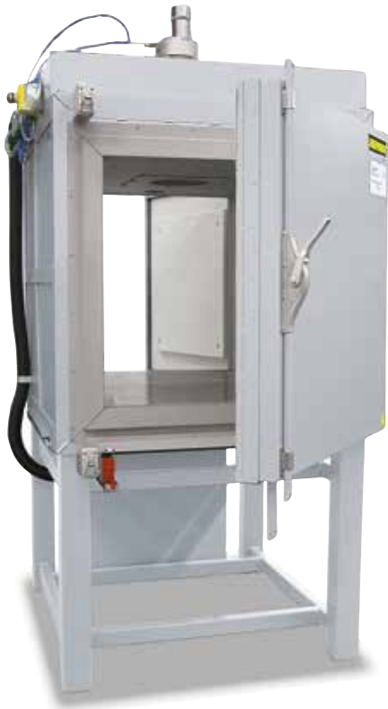
Horno de esclusa N 560/26HACLS con unidades de seguridad, carga por delante y salida posterior
