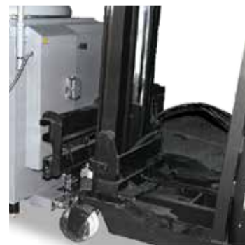
Soporte para carretilla elevadora bajo el horno
