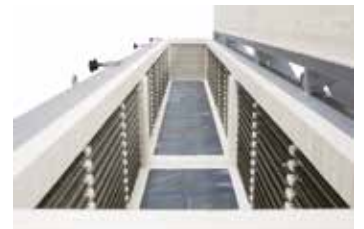
Cámara del horno S 5120/GS con alojamiento para la placa aislante para dividir en dos la cámara del horno
