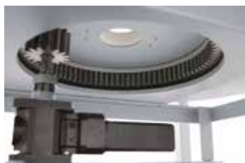
Accionamiento de corona dentada debajo del horno de solera giratoria
