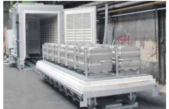
Horno de vagoneta por carretilla con sistema de gasificación
