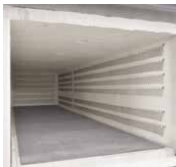
Aislante de fibra clasificada como no cancerígena y resistencias con en forma curvada para tiempos de proceso cortos
