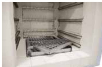
Rejillas de carga en la solera
