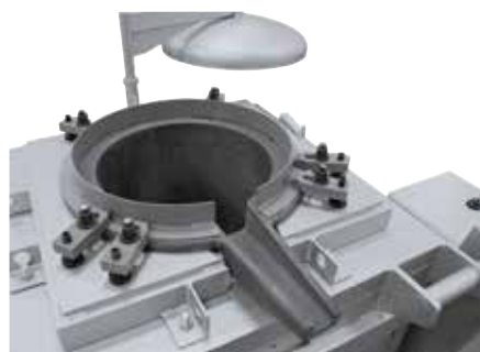
Crisol con soportes de suspensión especiales para cargas pesadas
