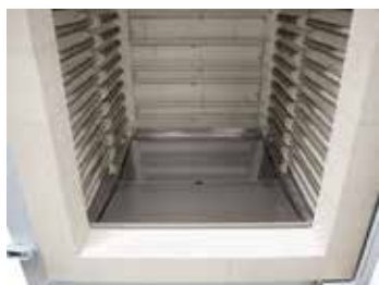
Cubeta de descarga en la solera
