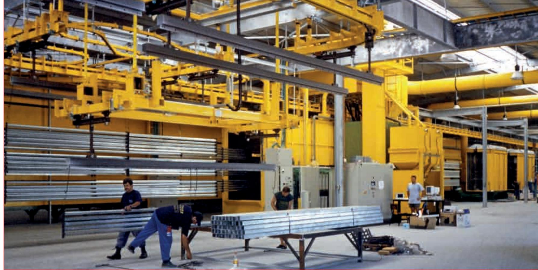
DURCHLAUFSTRAHMASCHINEN MIT HÄNGEBAHN TYP "TOR"
